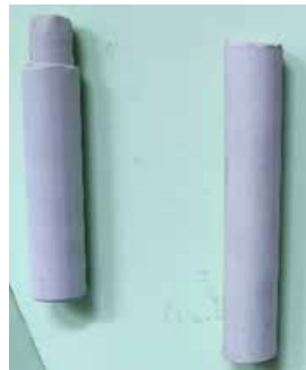
Рис. 5. Комплект штоків для передачі тиску
